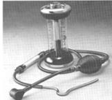
Le test de CO<sub>2</sub> peut être conduit **mécaniquement**. Activez une action de pompage complète lente et stable de 18.
